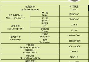
该材料以各种优质不锈钢为基体,表面覆着以PTFE和其它添加剂为主的低摩擦耐 摩编织物材料。这种材料结构相比一半三层复合材料具有更高的承载能力和更长 的使用寿命。主要运用于农用机械、建筑机械、汽机车底盘零部件、球阀、蝶阀 各种阀门,水泵及化工工业等重载低速而无法加油的场合。
